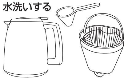
保温ポットの湯を捨て、内部が冷めたら水で軽くすすぎます。本体が冷めたらフィルターを外し、保温ポットフタ、メジャースプーンと一緒に水洗いします。これで準備完了です。
