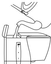
杯数分の水を水槽に入れて水槽ブタを閉じてください。水槽の目盛りはコーヒーのでき上がり量を示します。
