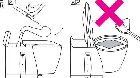
水槽に目盛「5」まで水道水を入れ(図1)、フィルターペーパー、コーヒー粉を入れずに(図2)5ページの「ご使用方法:5~9」に従いスイッチを入れます。水槽の水が完全になくなったらスイッチを切れます。
