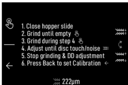
図18: ディスク距離の校正プロセス
