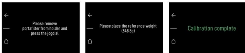
図17: ロードセルの校正プロセス
