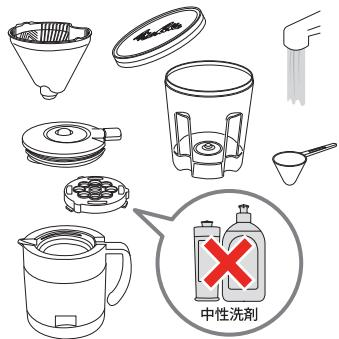
水ですすぎ洗いでください。浄水フィルター以外のもので汚れがひどい場合は、中性洗剤を水またはぬるま湯で薄め、柔らかいスポンジを使用して軽く洗ってください。その後、洗剤が残らないようにすすぎ洗いをしてください。
