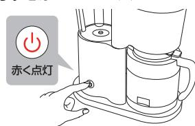
電源プラグをコンセントに差し込み、電源スイッチをオンにしてください。電源スイッチのランプが赤く点灯し、しばらくしてコーヒーの滴下が始まります。
