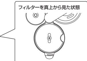
フィルターの向きに注意して、しづく漏れ防止弁とスイングフィルター底の穴を合わせます。
