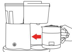
フィルターのしづく漏れ防止弁に保温ポットフタのコーヒー受け口が合い、口ゴが正面を向くように保温ポットを水平に挿入します。
