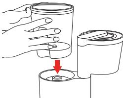
本体の突起に合わせて給水タンクを取り付けます。
