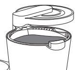
杯数分のコーヒー粉を入れ、スイングフィルターを閉めてください。コーヒー1カップ1杯につき付属メジャー スプーンすりきり1杯が目安です。
