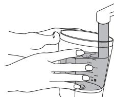
杯数分の水を給水タンクに入れてください。給水タンクの目盛りはコーヒーの出来上がり量を示します。
