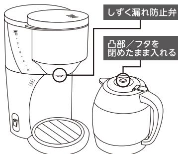
⑥コーヒーができあがったら、メインスイッチをOFFにし、フィルター内のコーヒーが完全に落ちきったことを確認して、ステンレス保温ポットをボトムプレートから引き出します。
