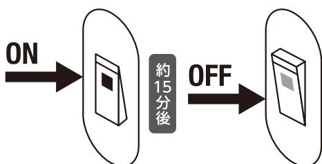
※1度使用してから約15分後に自動的に電源が切れます(赤いランプが消えます)。再びご使用の場合は、メインスイッチがOFFの位置に戻していることを確認してからご使用ください。
