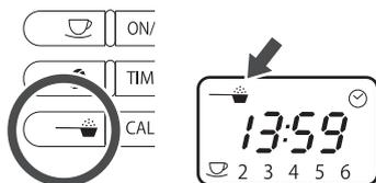
コーヒー粉ボタンを押してコーヒー粉モードに設定します。ディスプレイにコーヒー粉マークが表示されていることを確認してください。
