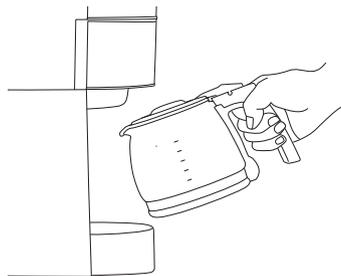
抽出が終了するとブザーが鳴って緑色ランプが点滅から点灯に替わり、保温モードに切り替わります。コーヒーが完全に落ち切ったことを確認してからグラスポットをゆっくり抜き、カップに注ぎます。保温モードが終わるとランプが消灯します。
