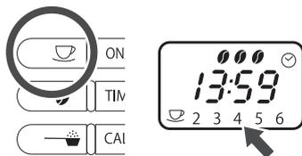
杯数ボタンを押してコーヒーを挽く量を設定します。水槽タンクに入れた水と同じ数字にセットしてください。
