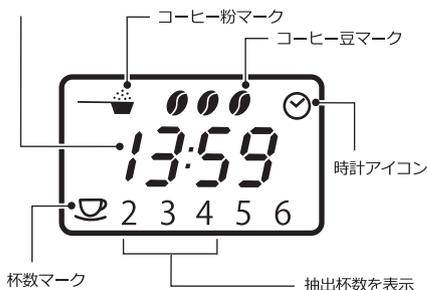
\* 杯数ボタンを長押し(2秒)するとディスプレイにライトが点灯します。消灯したい場合はもう一度杯数ボタンを押します。
